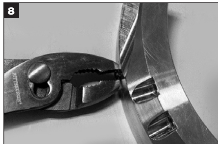
8 Fjern centreringsknapperne (6x) fra den udvendige diameter af rotationsholderen.
